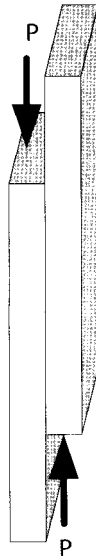
ภาพที่ 4. ลักษณะการทดสอบด้วยเครื่อง universal testing machine
